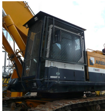
3. Risikobeurteilung erforderte Schutzmassnahmen: z. B. Nachrüstung eines Baggers mit Steinbrechergittern zum Schutz vor Querschlägeranprall
