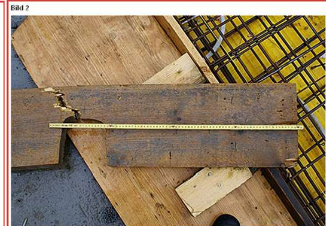
Das gebrochene Gerüstbrett (Breite 28 cm) mit der verhängnisvollen Aussparung (12 x 16 cm).
