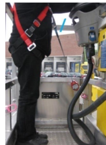
Img 3: Durante gli spostamenti usare il collegamento più corto
