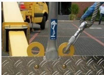
Img 1: Utilizzo dei punti di ancoraggio per i DPI definiti dal costruttore (3>KN), posizioni: vicino al piano di calpestio, altezza max. corrente intermedio, non al parapetto
