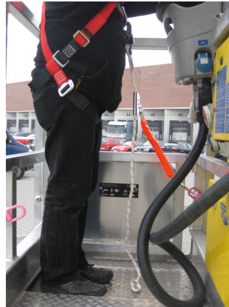
Bild 3: kürzest mögliche Sicherung beim Verfahren → Seileinstellvorrichtung anpassen!
