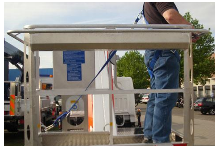
Bild 5: Vorsicht: kürzest mögliche Sicherung auch bei der Arbeit. Maximale Verbindungsmittellänge = 1.80m
