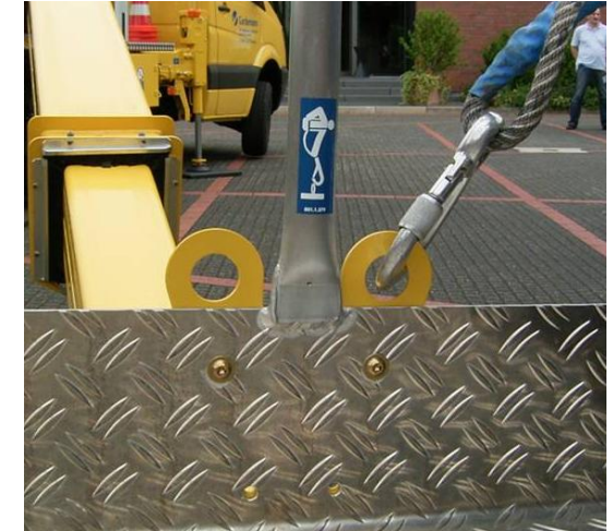
Bild 4: Immer die vom Arbeitsbühnenhersteller bezeichneten Anschlagpunkte (> 3kN) verwenden. Anschlagpunktposition: Bodennah, maximal Höhe Mittelholm. Niemals am Geländer sichern!
