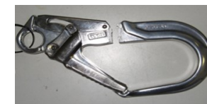
Img 10: uso non appropriato di un gancio (p. e. alluminio), può rompersi / conseguenza caduta
