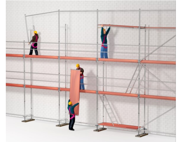
Img 2 Montaggio: sistema a parapetto montato dal piano inferiore
